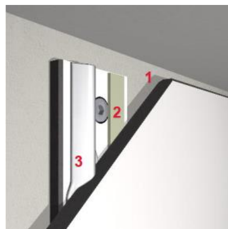
30 paveikslas. Viršutinė užbaigiamoji sieninių plokščių apdailos dalis
