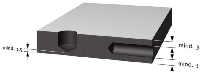
5 paveikslas. Mažiausias išgręžtų skylių atstumas nuo plokštės krašto
