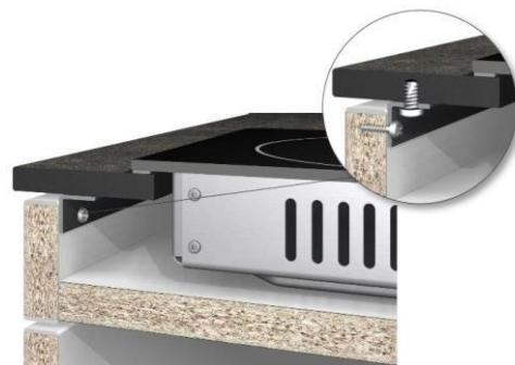
51 paveikslas. Stabilizavimas naudojant metalinį skersinį
