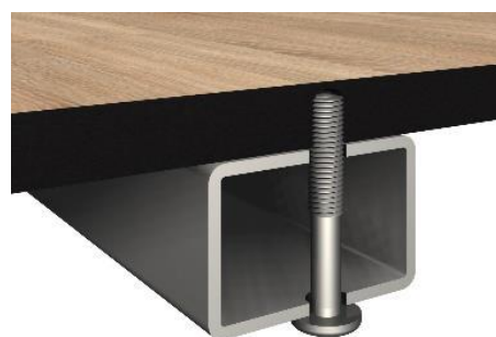
40 paveikslas. Rekomenduojamas kompaktinio laminato stalviršio tvirtinimas
