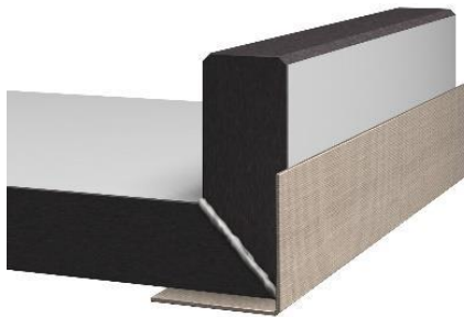
18 paveikslas. Užlenkite paaukštinimą ir sutvirtinkite lipnia juosta
